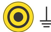
Saída para aterramento
